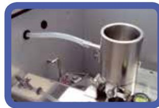
Die Abbildungen oben zeigen den Anschluss an AMS der Firma Lely. Das Bild rechts zeigt die Führung des Milchschauchs im Ori-Collector. Durch den Einlass in der Seitenwand kann der Deckel des Ori-Collectors während der Probenziehung geschlossen werden.
