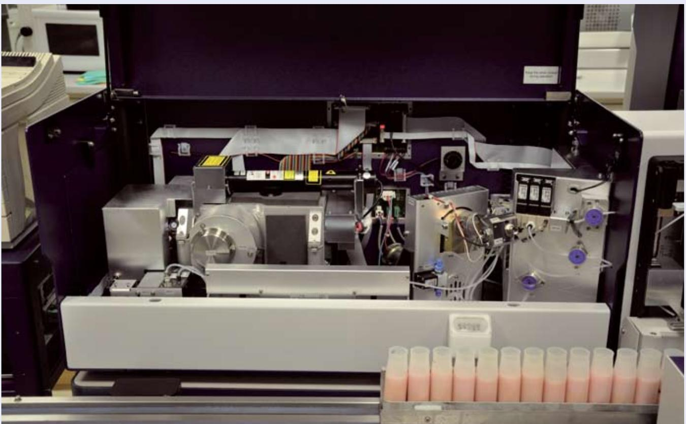
Mit den modernen Untersuchungsgeräten im Prüflabor des LKV NRW ist es möglich, für jede einzelne Rohmilchprobe das Spektrum im mittleren Infrarotbereich zu ermitteln.
