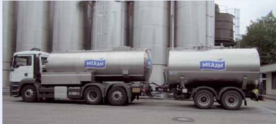
Der Tandemanhänger wurde anfangs mit 3.800 kg Leergewicht konstruiert. Aus Stabilitätsgründen wurde nachgebessert, sodass diese Fahrzeuge heute ca. 4.000 kg leer wiegen. Neben dem Gewichtsvorteil fällt das Rangieren hier einfacher.
