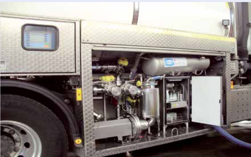
Das Tiger-Milchannahmesystem baut bereits frühzeitig Vacuum in einem Vorratsbehälter auf und benötigt keinen schweren Gasabscheider. In Verbindung mit einem kleinen Probenfach und einem leichteren Kühlaggregat werden hier ca. 300 kg Eigengewicht eingespart.
